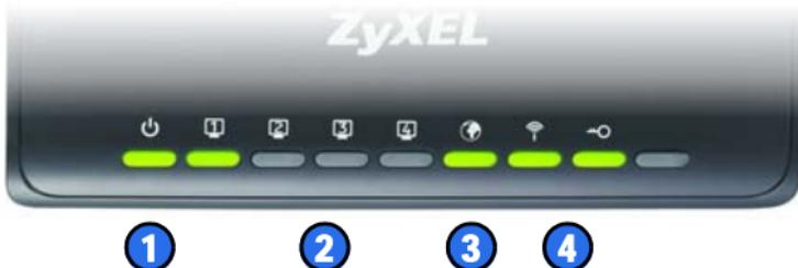
*LED's zijn groen als het apparaat aanstaat en op het netwerk is aangesloten.*
