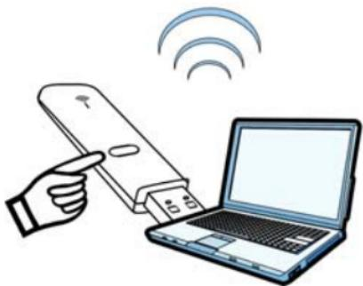
**3** Druk op de WPS knop van het compatibele apparaat (zoals de NWD-270N) binnen 2 minuten nadat u de knop op de NBG4604 heeft ingedrukt.
