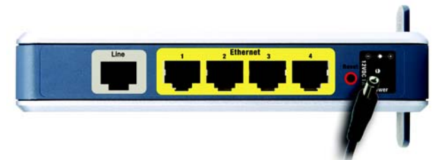
Figure 4-3 : Connexion de l'alimentation
