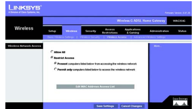
Bild 5-17: Wireless Network Access (Trådlös nätverksåtkomst)
