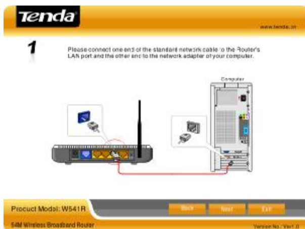
Obr. 1.3 – Připojení routeru k počítači pomocí patch kabelu
