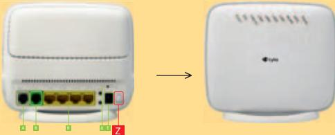
Ενεργοποίησε το modem / router πατώντας το κουμπί On / Off (Z) στην πίσω πλευρά του modem / router. Η φωτεινή ένδειξη Power στο μπροστινό μέρος της συσκευής θα γίνει πράσινη. Η σύνδεση DSL θα συγχρονίσει όταν η φωτεινή ένδειξη DSL σταματήσει να αναβοσβήνει και σταθεροποιηθεί σε πράσινο χρώμα.
